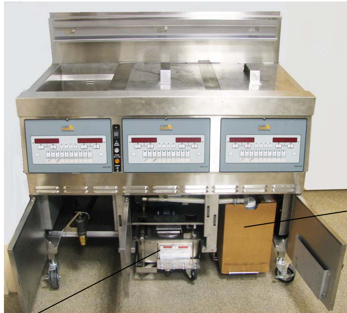
5 A. Bandeja de drenaje, B. garrafa JIB (garrafa en el interior de la caja)
